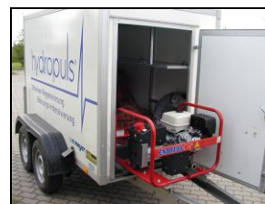
Rimorchio aperto con aggregato elettrico
