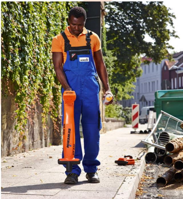
L'UT 830 è lo strumento ideale per coloro che desiderano un cercaservizi preciso, affidabile e versatile: anche in condizioni difficili la frequenza di 83 kHz si è rivelata infatti molto efficace per la localizzazione attiva di reti, condotte e cavi interrati. Particolari funzionalità tecniche consentono inoltre di ottenere risultati rapidi e accurati anche durante la localizzazione passiva di tubazioni e cavi sotto protezione catodica.
