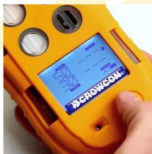
grande display grafico retroilluminato con possibilità di ruotare lo schermo di 180° per agevolare la lettura quando si indossa il T4
