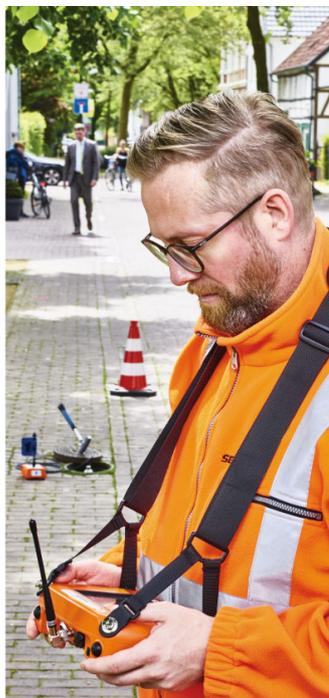
Il SeCorrPhon AC 200 è uno strumento completo per la ricerca professionale delle perdite idriche. Dalla prelocalizzazione con l'asta di ricerca piezo, alla precisa localizzazione con correlatore e geofono, l'abile combinazione di questi diversi sistemi e le soluzioni tecnologiche di punta permettono di determinare con precisione la posizione della perdita. Con poche semplici mosse si passa rapidamente ed agevolmente da un'applicazione all'altra. In combinazione con idonei accessori,
