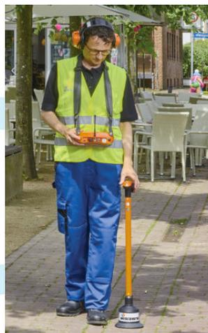
impiego del geofono per la localizzazione esatta della perdita
