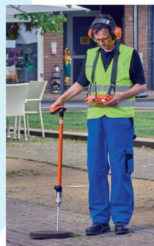
prelocalizzazione mediante ascolto diretto dei punti accessibili (fitting, ecc.)
