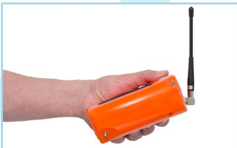
trasmettitori con 3 filtri passabanda per impostazione mirata prima della trasmissione
