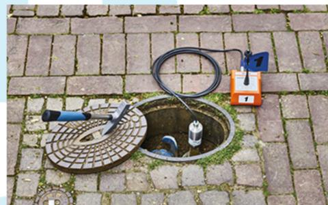
trasmettitori con accensione automatica ad inserimento microfono
