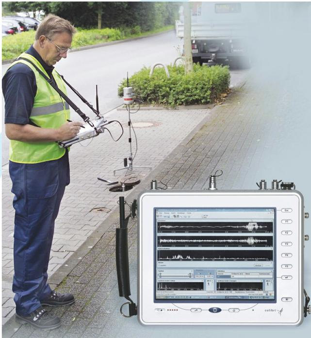
Lo sviluppo del nuovo correlatore full-digital SeCorr 300 ha portato a ridurre al minimo i fattori di disturbo nella ricerca delle perdite idriche.
