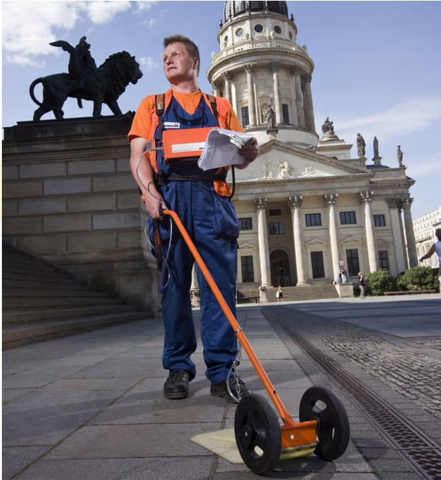
Strumento di riferimento nella ricerca sistematica delle fughe di gas, il PORTAFID è dotato di un affidabile detettore a ionizzazione di fiamma (FID) controllato da microprocessore per la rilevazione di metano.
