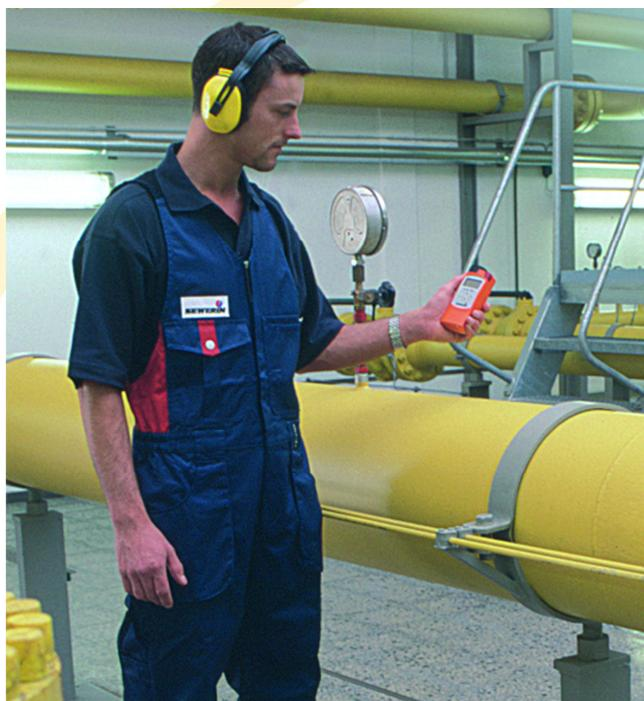
L'EX-TEC PM4 riunisce tre funzioni in un unico strumento: esplosimetro, cercafughe gas e rivelatore di gas esplosivi.
