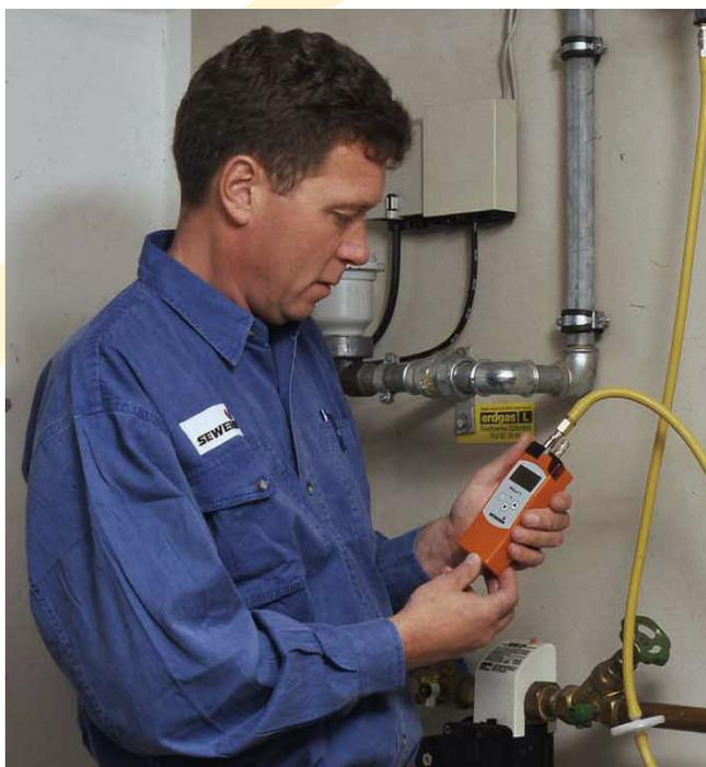
Il Minilec 4 è uno strumento multifunzione per la verifica della tenuta di impianti interni con metodo diretto ed indiretto secondo la norma UNI 11137-1.
