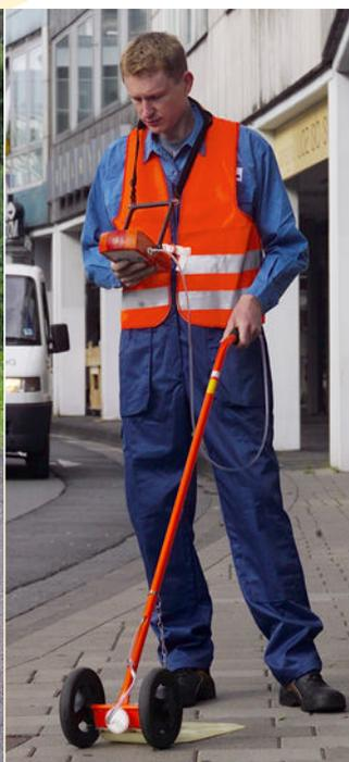
Questa nuova linea di apparecchi di punta della Sewerin fornisce alle aziende di distribuzione del gas un unico e semplice strumento di lavoro per tutte le attività inerenti la rilevazione, la ricerca e la localizzazione delle fughe di gas (con funzione esplosimetro, segnalazione carenza d'ossigeno e allarme gas tossici).
