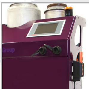
ElastoFlake è ideale per il risanamento di condotte fognarie all'interno di edifici, in quanto è possibile riabilitare vecchie tubazioni senza sostituirle, senza rompere pavimenti o pareti e senza creare disagi agli inquilini
