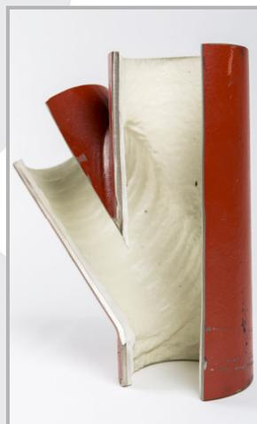
la particolare tecnologia a spruzzo riveste le superfici interne della condotta con uno strato liscio e duraturo, senza danneggiare la struttura pre-esistente
