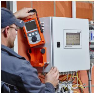
**BioControl 2:** modello base con 2 ingressi gas, ideale per impianti di piccole e medie dimensioni
