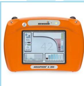
ricevitore IP67 con grande display VGA touch screen ad alta visibilità: utilizzabile anche con guanti, insensibile a sporco, polvere ed umidità
