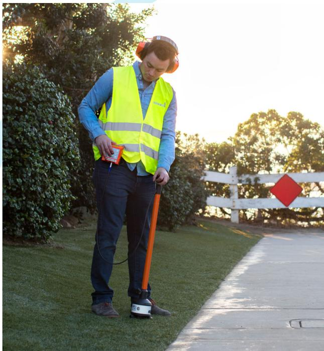
Il sistema A 150 della famiglia di apparecchi AQUAPHON combina il ricevitore compatto A 150 con i microfoni piezo ad alta sensibilità del collaudato modello A 200: il risultato è un sistema pratico e professionale per la prelocalizzazione su armature e fittings e la localizzazione esatta delle perdite idriche. Abbinato ai microfoni alta fedeltà e ad una cuffia radio senza fili, l'A 150 offre un'eccellente qualità di riproduzione del suono. Per un'identificazione af-
