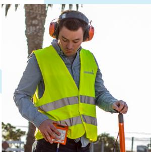
varie modalità d'impiego per il ricevitore A 150: sul fianco con clip da cintura oppure al collo con cinghia di trasporto
